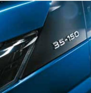
Система обозначений для нового DAILY крайне проста и интуитивна: код обозначает полную массу автомобиля (в центнерах) и его мощность (в лошадиных силах).
